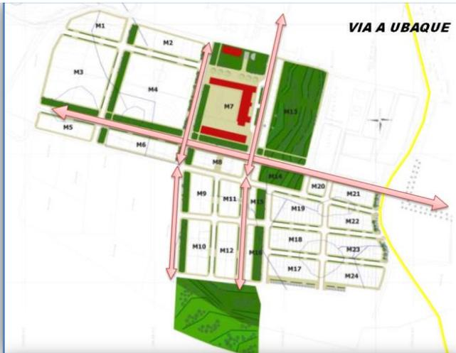
El trazado Vial proyectado, da continuidad al trazado existente. Se plantean 3 vías de 10 m de ancho de calzada que se localizan entorno a el centro cívico para no congestionar el sector; la Carrera 4, Carrera 5 y Calle 7 Sur, la distancia entre paramentos varía según el sector.
